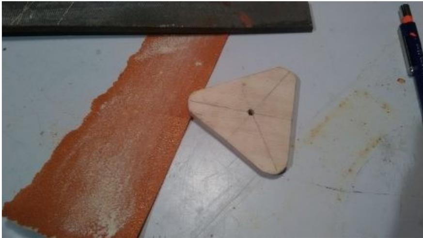
Das Loch für das Kugellager hab ich mit einem sogenannten Stufenbohrer gebohrt. Jede Stufe ist 2mm dicker als die Vorherige. Bohrt lieber eine Stufe weniger und macht den Rest mit Schleifpapier. Das Lager muss ziemlich stramm sitzen. Wenn ihr nur ein bisschen zu viel bohrt, ist das Lager lose und fällt raus
