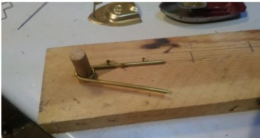
Die Biegelehre mit einem fast fertig gebogenen Spiralverdampfer.
