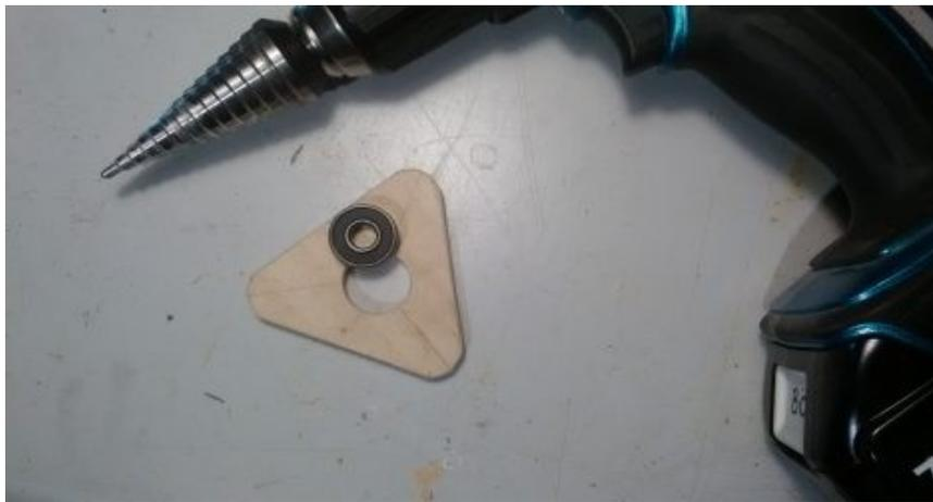
Setzt jetzt das Lager zum ersten mal ein und versetzt den Spinner in Schwung. Aber nicht flach, sondern hochkant. Wenn am Ende eine Seite nach unten pendelt, ist diese Seite zu schwer. Also müsst ihr da mit der Feile noch ein paar mal drüber.
